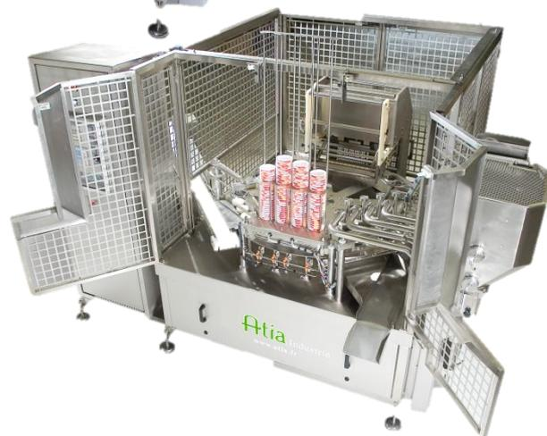
Cette machine à plateau circulaire allant de 3 à 5 pistes, permet de dépiler, remplir et fermer des pots de 68 mm à 115 mm de diamètre avec une hauteur maximum de 100 mm.
